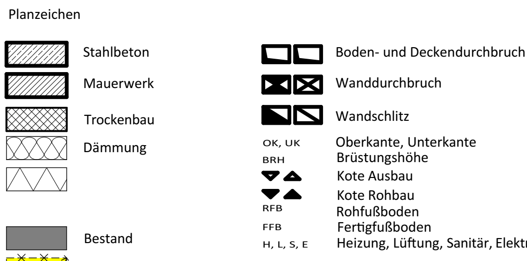
LEGENDE SCHULTZPLAN H+S LE FERTIGE HÖHE FFB ROHFUSSBODEN DE ROHBAU HÖHE FFB FERTIGER FUSSBODEN OK OBERKANTE FB FUSSBODEN UE UNTERKANTE DE DECKE WS WANDGESCHÜTZ WA WANDAUSSPARUNG DA DÜBELANFESTENBRUCH DA DECKENANFESTENBRUCH FB FUSSBODENDURCHBRUCH SA SCHWELLENUSPARUNG BO BODENANSPARUNG PH ROHRHÖLE DK DECKENKANAL HVN HEIZKÖRPERFERNISCHE BD DECKENDURCHBRUCH V VORMAUERUNG H HEIZUNG S SANITÄR L LÜFTUNG F FENSTER/SCHWELLENRICHTUNG
